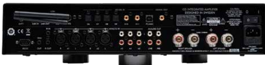
Die Rückseite des I35 Primare informiert über die vielseitige Funktionalität des Geräts. Neben der Standard-Ausführung sind hier das Digital- und das Netzwerk-Modul erkennbar
