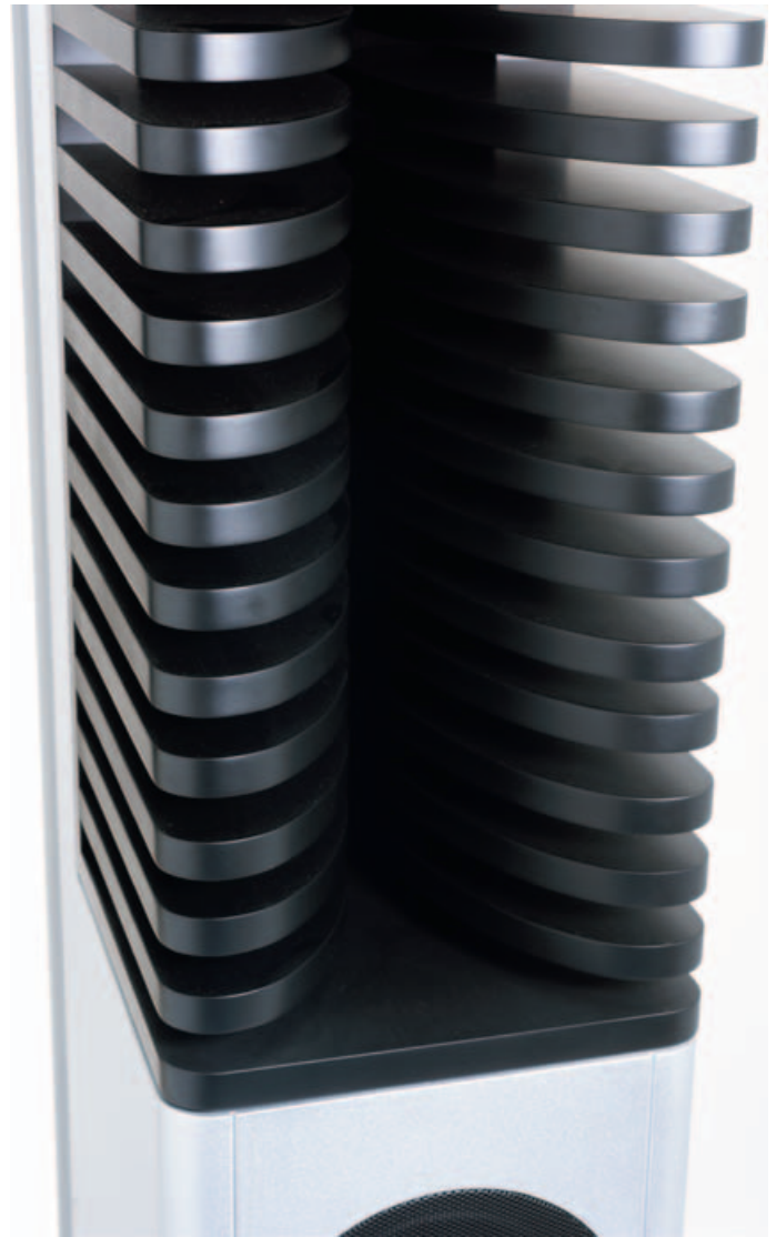
Die hölzernen Schalllinsen sorgen bei den rückwärtigen Schallanteilen für geordnete, von Interferenzeffekten freie Verhältnisse, was die wandnahe Aufstellung einfacher macht, und verbessern zugleich den Wirkungsgrad im Mitteltonbereich.
