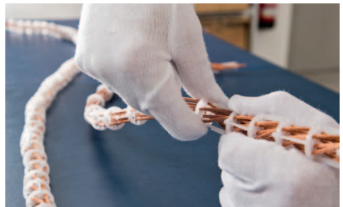
Danach wird die Gesamtkonstruktion verdreht zu einer Helix-Struktur. Um der perfekten Luftisolation so nahe wie möglich zu kommen hat in-akustik einen speziellen Clip entwickelt. Im Kabelinneren bildet eine Vielzahl dieser Clips das tragende Gerüst.
